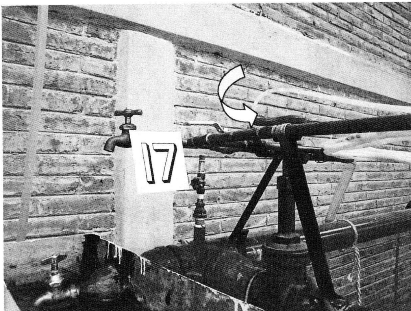
*Fotografía 8. Diferentes nudos de toma de presión conectados a la celda diferencial.*
